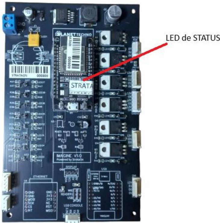
O LED de STATUS fornece informações sobre o estado geral da comunicação do equipamento. Quando o módulo está operando normalmente o LED pisca a cada 2 segundos.
