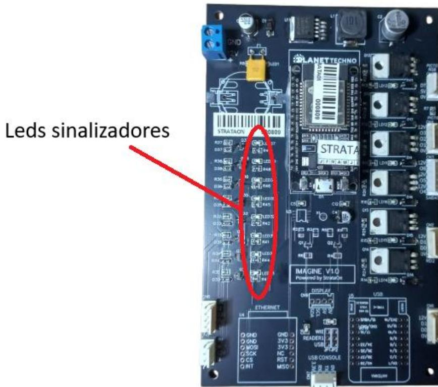
As conexões e os leds correspondentes podem ser vistos abaixo:
