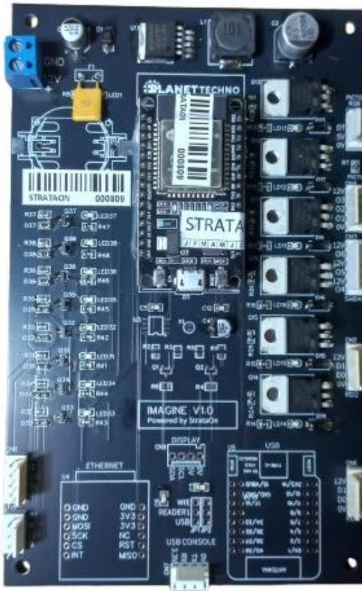
O Módulo Recolhedor de Comandas **IMAGINE 1000** é um dispositivo desenvolvido com as mais modernas tecnologias IOT (*Internet Of Things*) que gerencia a máquina recolhedora de comandas fabricada pela Planet.
